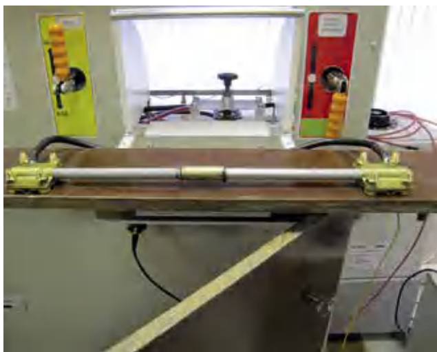
Испытание элементов УЗК импульсным током
