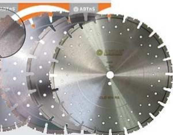
Алмазные диски для бензорезов имеют наваренные лазером алмазные сегменты различной формы. Применяется данный алмазный инструмент для резки бетона, армированного бетона, тротуарной плитки, кирпича и других строительных материалов. В зависимости от формы сегментов и их количества (на дисках одного диаметра) диски могут быть ориентированы на высокий ресурс либо на высокую производительность.
